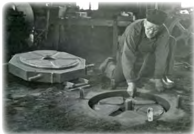
Johan Tesell gör handformning med svart sand direkt i golvet.
